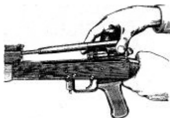
Отделение затворной рамы с затвором
