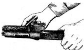
Отделение газовой трубки со ствольной накладкой
