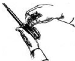
Отделение затвора от затворной рамы
